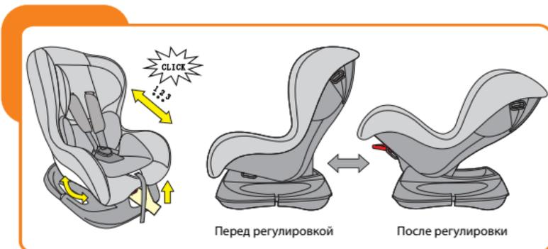
Детское сиденье можно отрегулировать в 3 разных позициях - позиция 1, позиция 2 и позиция 3. Если кресло установлено против направления движения (группа 0 +), может быть использовано только положение 3. Потяните рычажок под сиденьем автокресла в передней его части вверх, а затем потяните и толкните сиденье вперед или назад. Отпустите рычажок и надавите на него, пока не услышите "щелчок".
