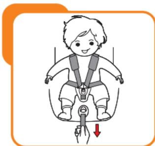
Потяните ремни вверх, удаляя провисание, затем потяните регулятор. Ремни должны быть отрегулированы так плотно, насколько это возможно, не вызывая дискомфорт для Вашего ребенка. Свободные ремни могут быть опасными. Проверьте натяжение ремней каждый раз, когда сажаете ребенка в автокресло.
